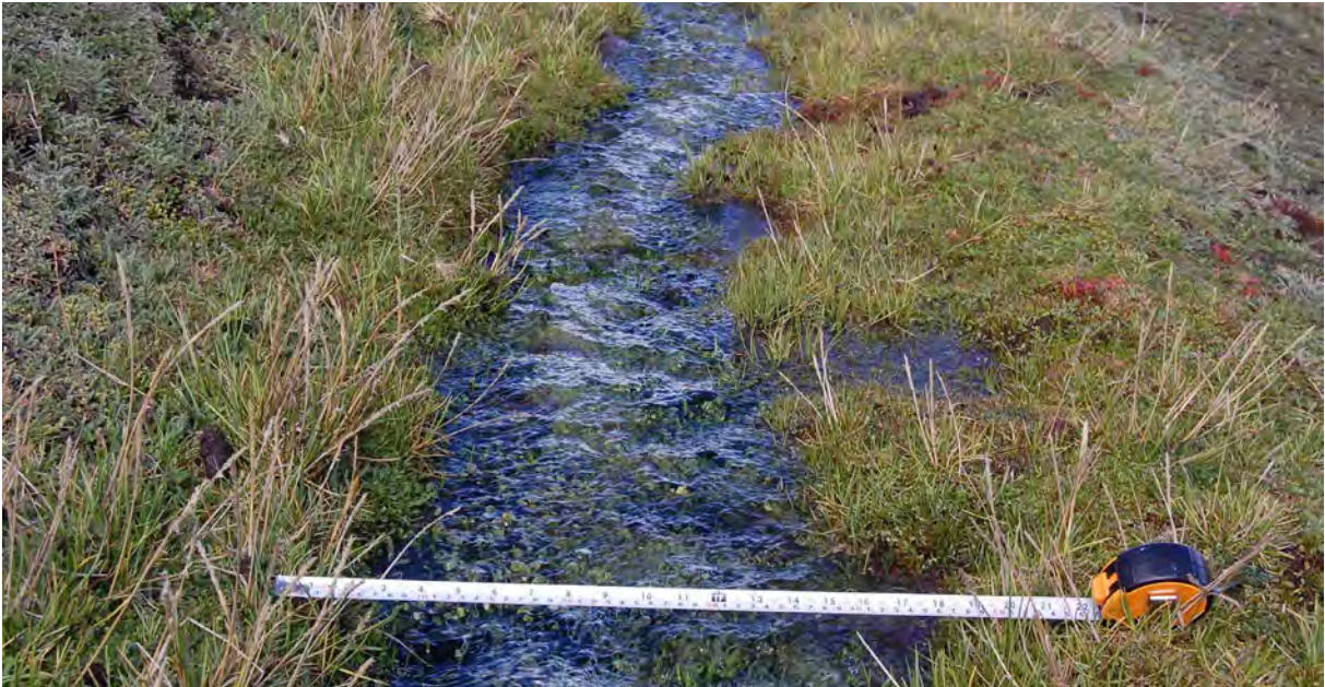
Figura N° 21: Aforo de caudal en materiales coluviales Fotografía: Rene Pumayalli-Unu Kamachiq
