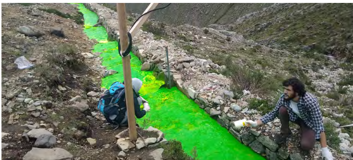
Figura N° 13: Inyección de la fluoresceína en el primer punto de aforamiento, en la Amuna Saywapata
