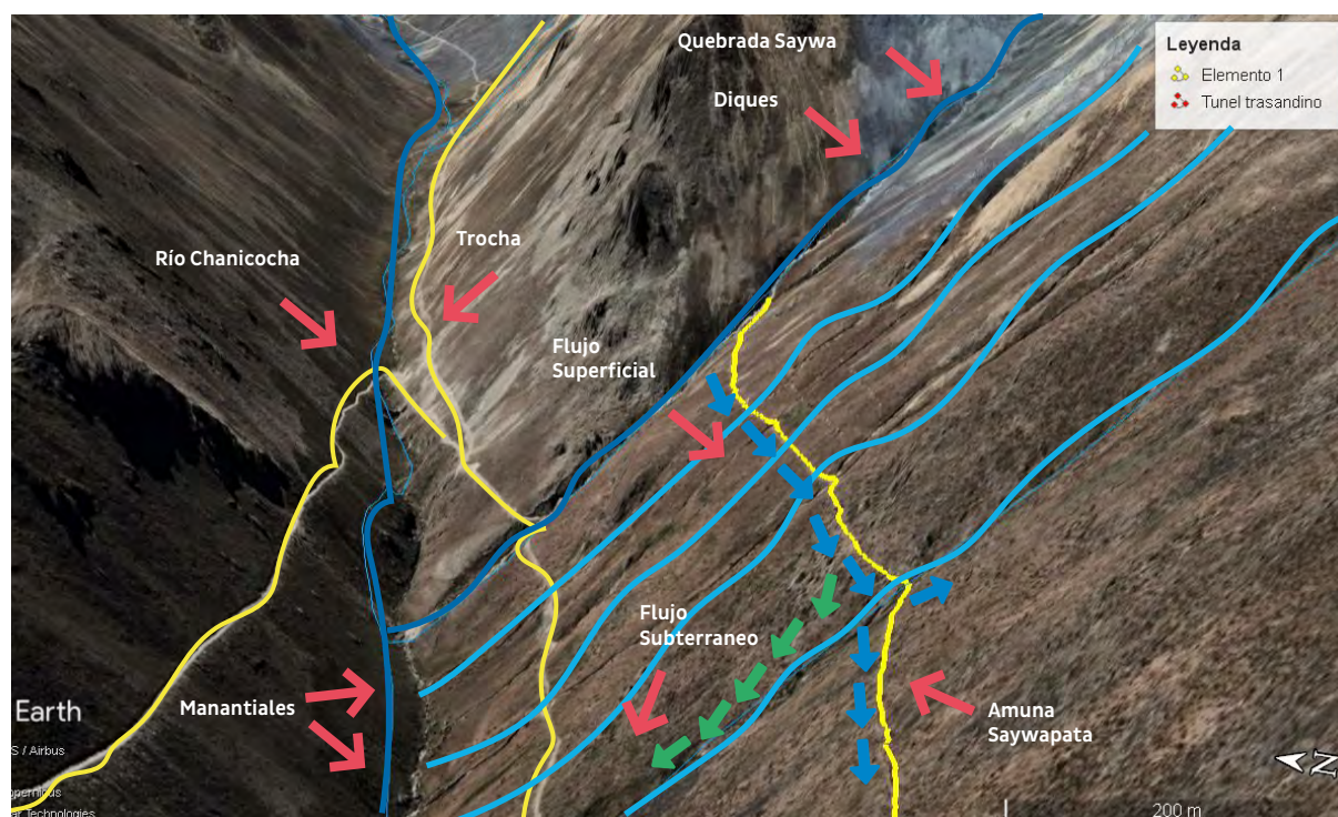
Figura N° 12: Esquema en 3D del flujo subterráneo entre la Amuna Saywapata y el río Chanicocha Fuente: Elaboración Propia
